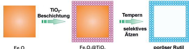
**Hohle  $\text{TiO}_2$ -Kästchen** mit Abmessungen im Submikrometerbereich sind über eine Templatstrategie zugänglich. In einem Solvothermalverfahren wird zunächst eine  $\text{TiO}_2$ -Schicht auf  $\text{Fe}_2\text{O}_3$ -Würfeln als Templat abgeschieden, die beim Tempern
